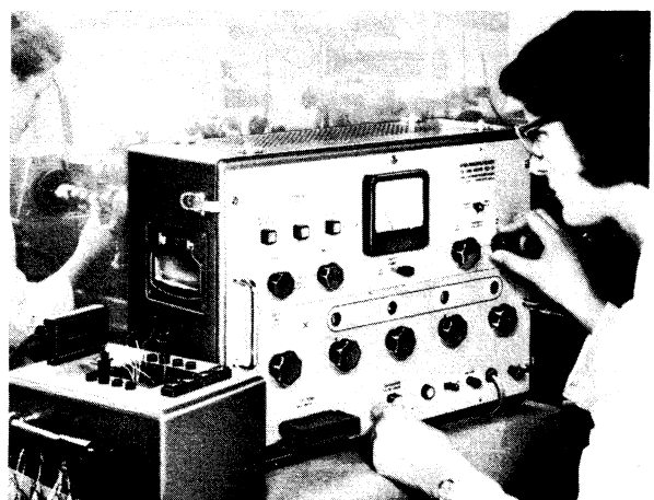
Windungszahlenmeßgerät WZL-181 von Wandel & Goltermann; links vorn der Kasten mit dem Prüfling
